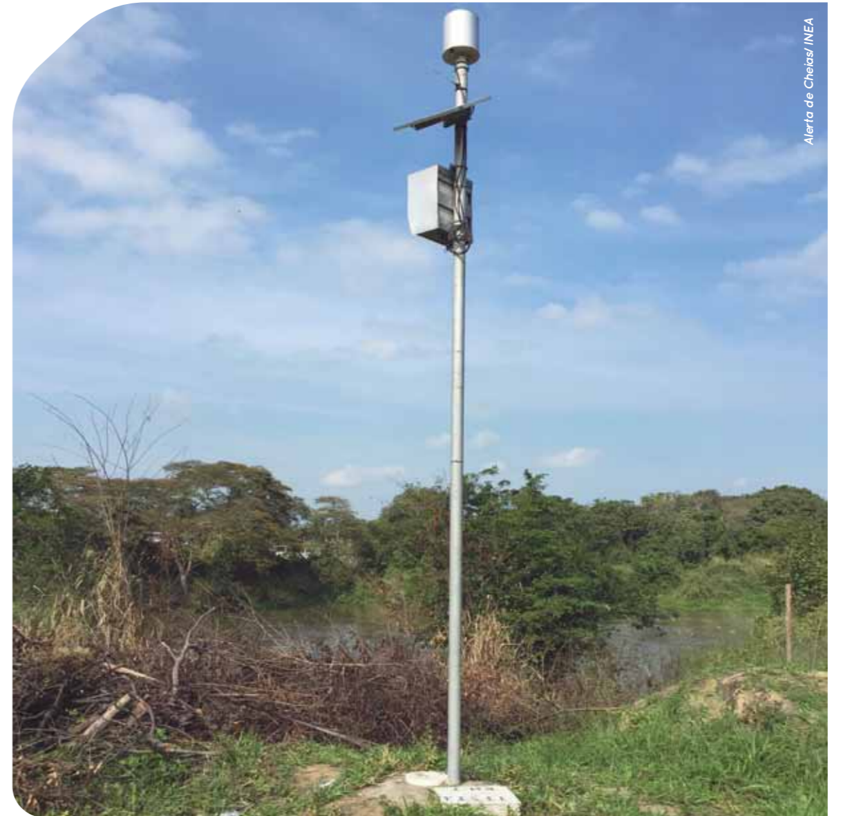
Modelo de Estação Hidrometeorológica usado pelo Sistema de Alerta de Cheias do INEA para coletar dados
