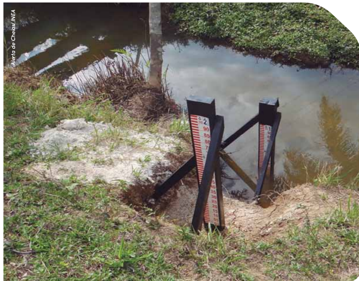
Conjunto de réguas usadas na medição do nível de rios
