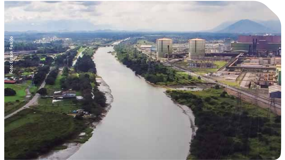
Canal de São Francisco (foz do Rio Guandu): a captação de água pelas indústrias locais tem sido prejudicada pela diminuição da vazão transposta, por sua vez, decorrente do aumento da intrusão salina
