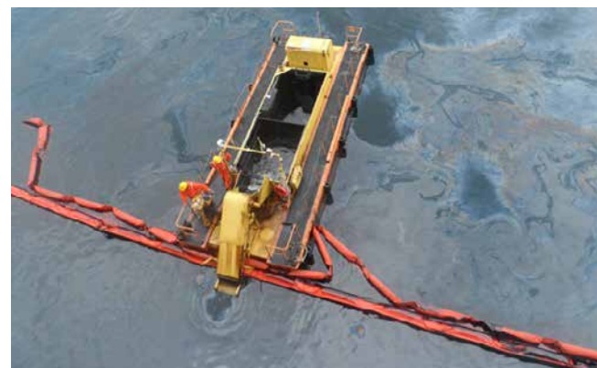
Figura 46: Recolhedor utilizado no combate ao óleo para montar cerco com barreiras de contenção no dia 16 de março de 2015
