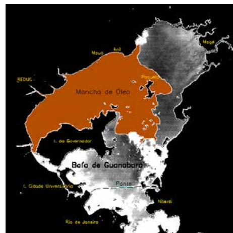
Figura 21: Mancha estimada para o dia 19 de janeiro de 2000. Área calculada a partir de imagens de satélites foi de 133,45 km 2 Fonte: Kampel e Amaral (2001)
