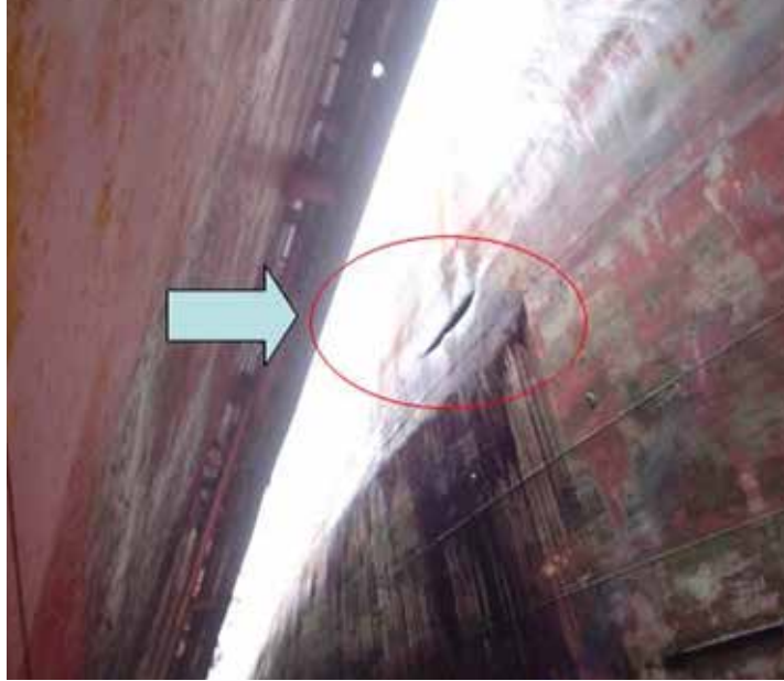
Figura 30: Rasgo no navio Saga Mascot que provocou o vazamento de 14 mil litros de óleo na Baía de Guanabara Fonte: Geopem
