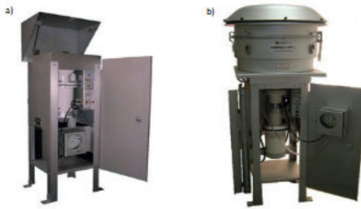
**Figura 12.** Amostradores AGVs das estações semiautomáticas de monitoramento da qualidade do ar e meteorologia do INEA. (a) PTS, (b)  $\text{PM}_{10}$  ou  $\text{PM}_{2,5}$ .
