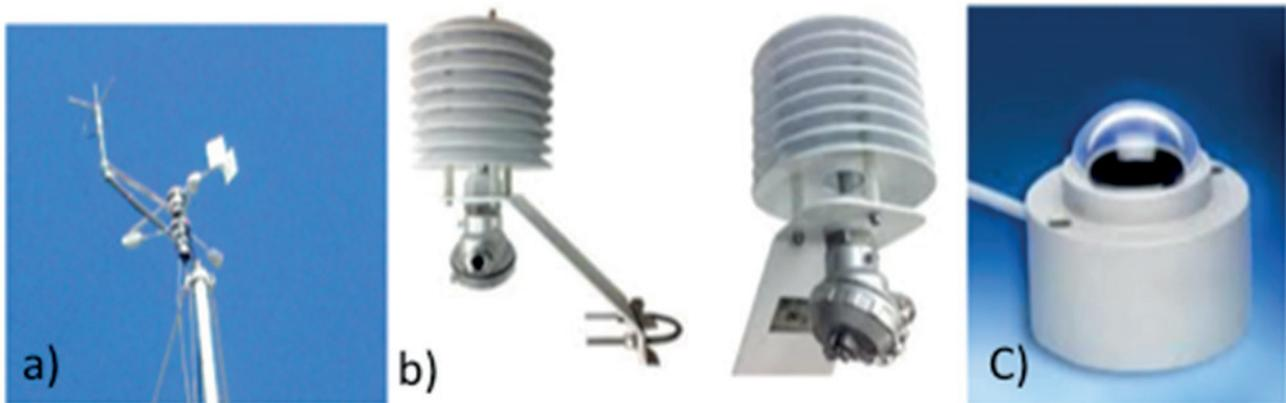
**Figura 11.** Sensores Meteorológicos de monitoramento ambiental que equipam as estações automáticas de Monitoramento da Qualidade e Meteorologia do Ar do INEA: (a) sensor de direção e velocidade de vento, (b) sensor de temperatura e umidade relativa, (c) sensor de radiação solar
