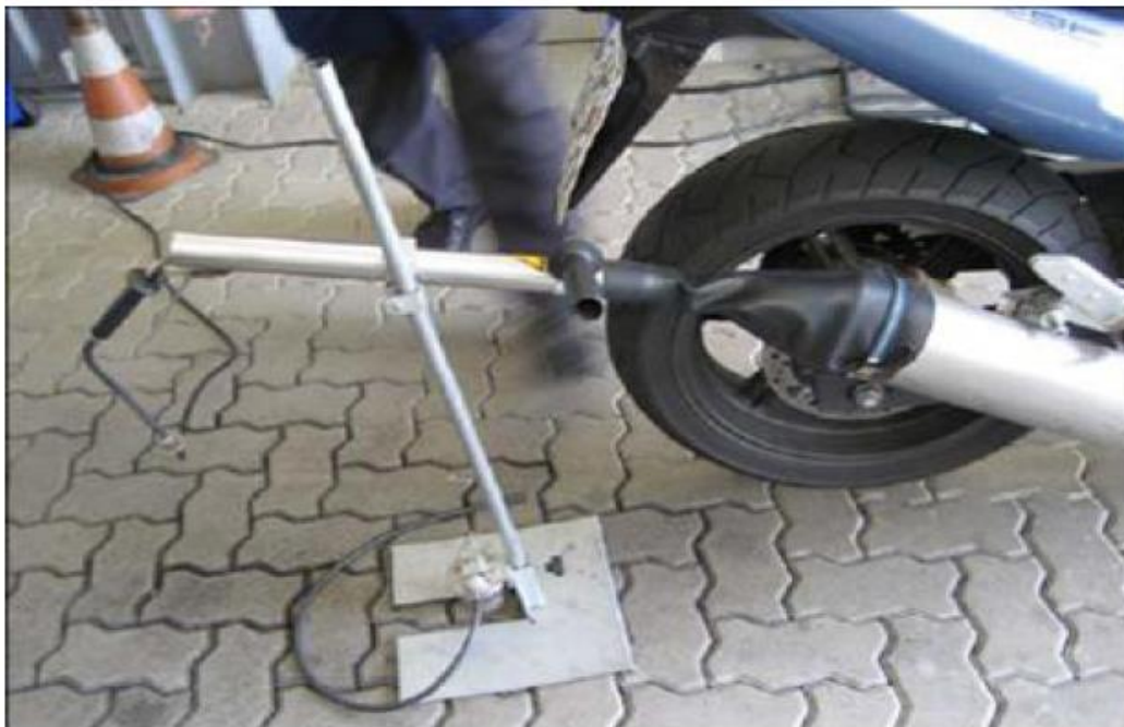
Figura 3 – Exemplo de Adaptador de extensão com vedação externa FONTE: IN IBAMA 06/09
