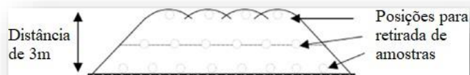
Figura 1 – Seção transversal do topo da pilha de processamento de escória de aciaria
