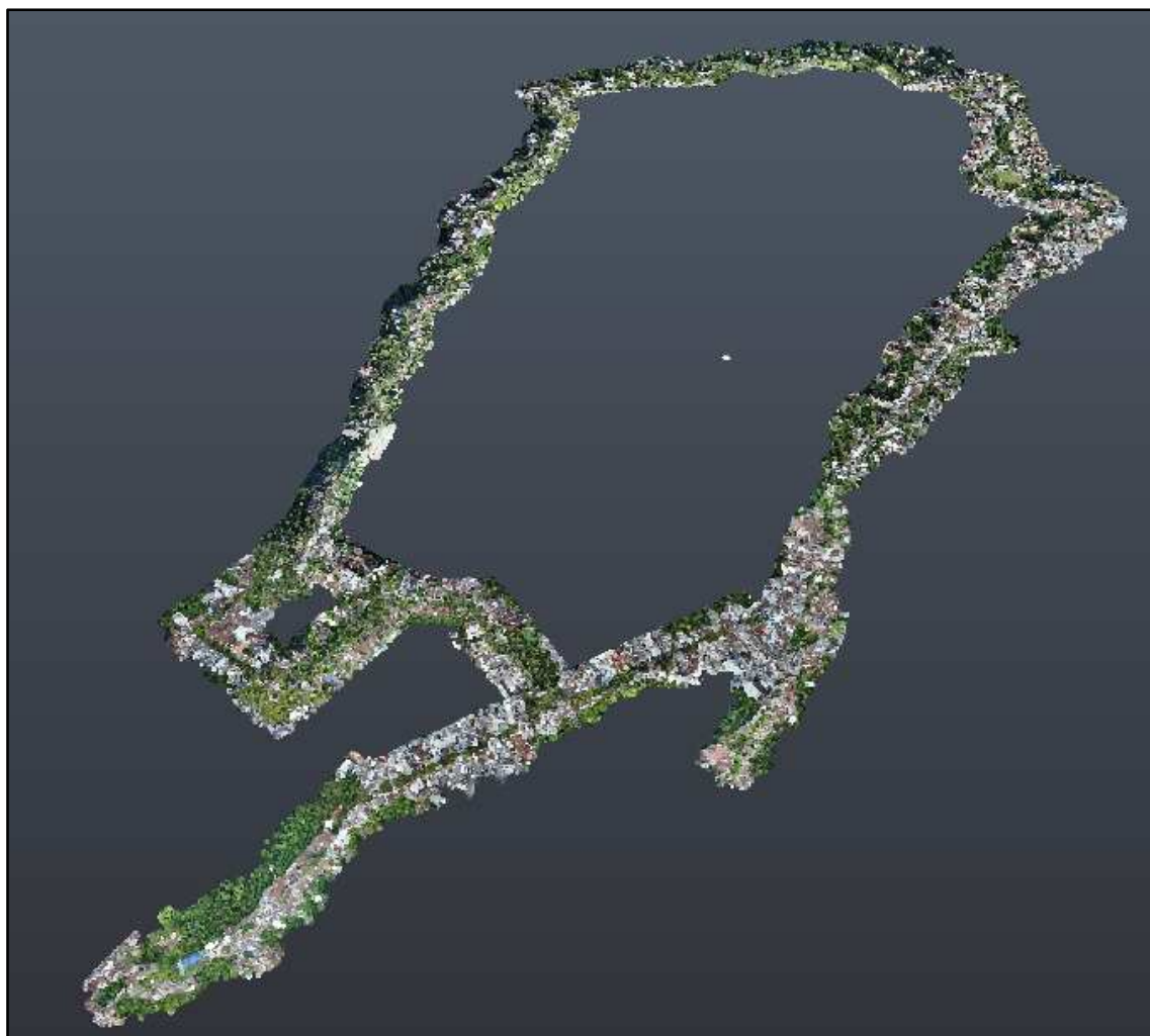
Figura 4.4 - Nuvem de Pontos Área de Interesse Obtida Através do Aerolevanteamento com Drone
