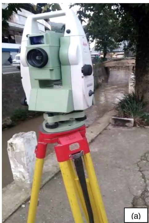
Figura 6.3 - Levantamento Topobatimétrico com Estação Total
