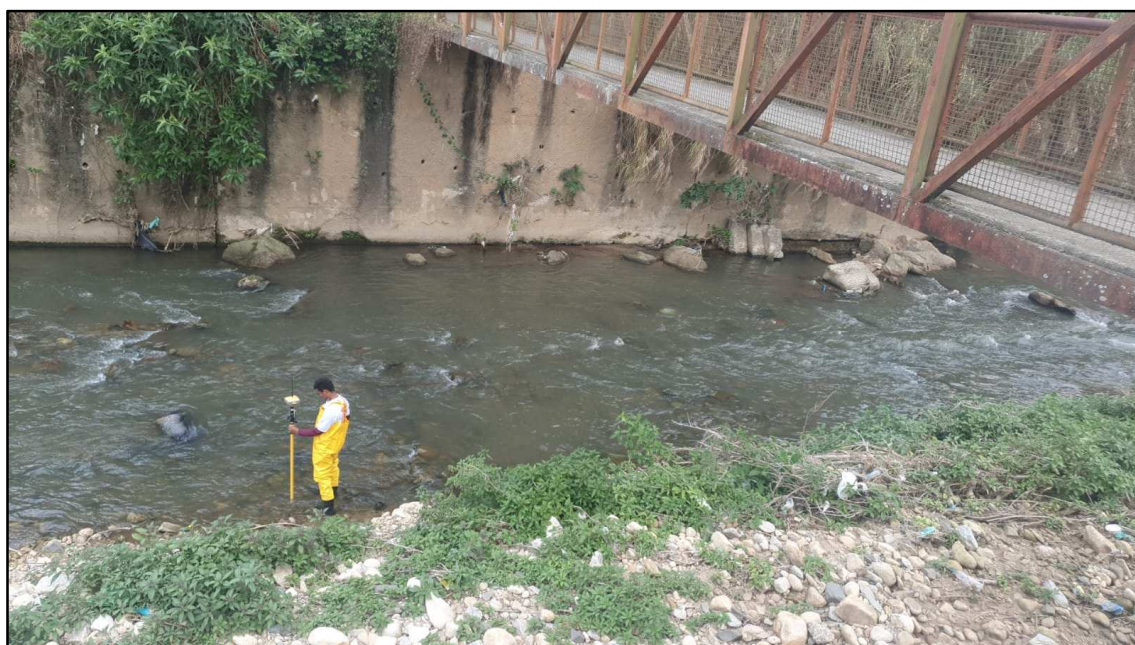
Figura 6.1 - Levantamento Topobatimétrico com GNSS em Modo RTK
