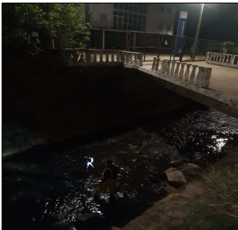
Figura 5.6 - Levantamento Topográfico com 3D Laser Scanner Faro X130
