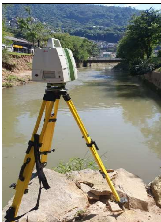
Figura 5.1 - Levantamento Topográfico com 3D Laser Scanner Leica C10
