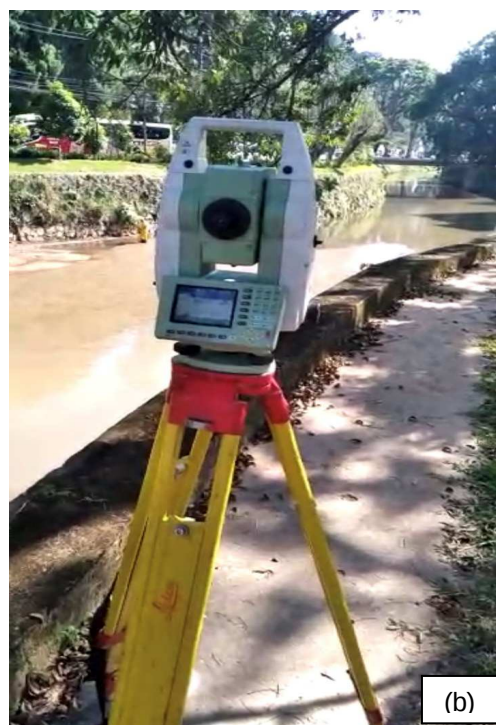
Figura 6.3 - Levantamento Topobatimétrico com Estação Total
