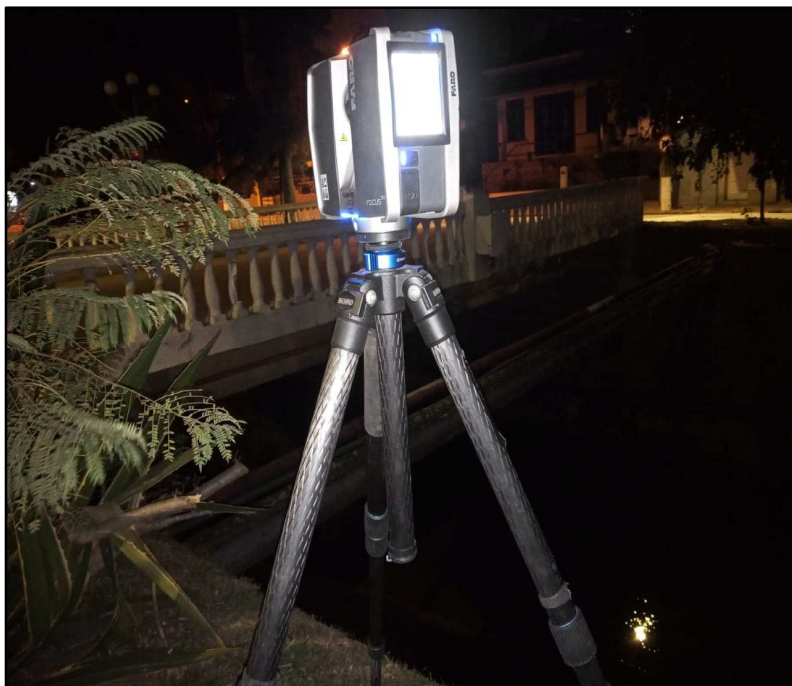
Figura 5.8 - Levantamento Topográfico com 3D Laser Scanner Faro S120
