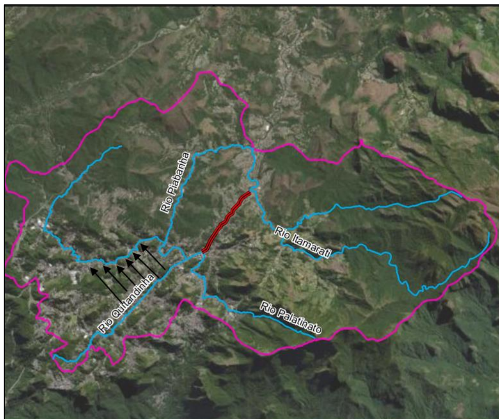
Figura 2-12 - Desenho Esquemático com a Implantação das Bombas para Transferência de Vazão do Rio Quitandinha para o Rio Piabanha
