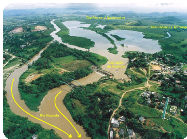
Figura 1 – Área de captação da ETA Guandu com a indicação dos rios formadores da lagoa de captação: Rios Poços/Queimados e Ipiranga
